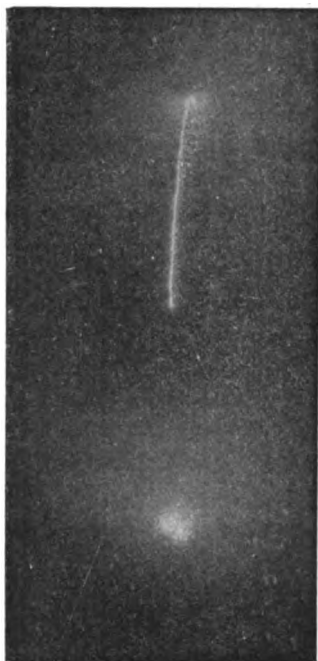
Fig. 3. — Étincelle globulaire ambulante. L'expérience est arrêtée alors que l'étincelle n'est rendue qu'à la moitié de la distance entre les deux pointes.
