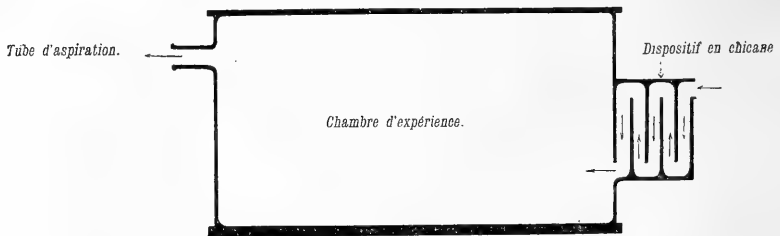
Fig. 16. — Appareil pour l'étude de l'influence des radiations monochromatiques sur les animaux à respiration aérienne (Voy. p. 414).
