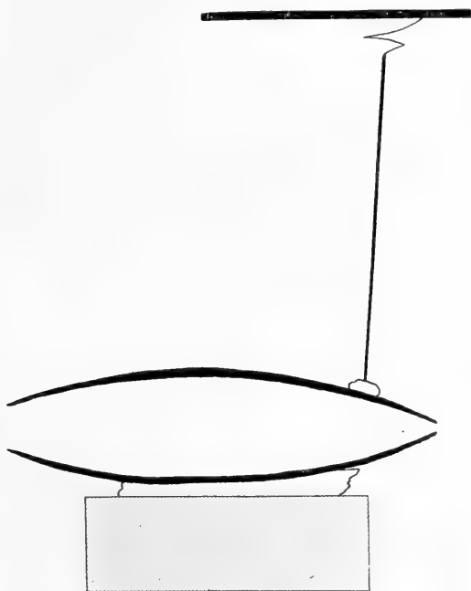
Fig. 3. — Représentation schématique du dispositif employé pour l'inscription graphique des mouvements des valves chez un Acéphale.
