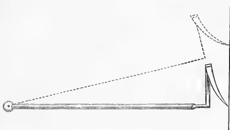
FIG. 34. — Pointe élastique traçant sur une glace enfumée.
