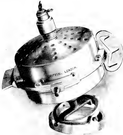
FIG. 5.—MOTOR-GYROSTAT ON GIMBALS.
