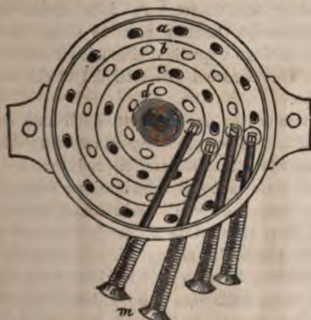
Fig. 10. Anelli e coperchio di uno dei tamburi della sirena.
