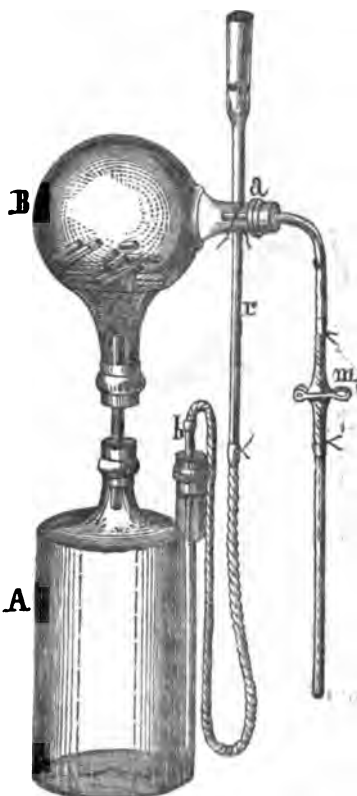
Fig. 27. Apparato Brugnatelli per fabbricare gas idrogeno.
