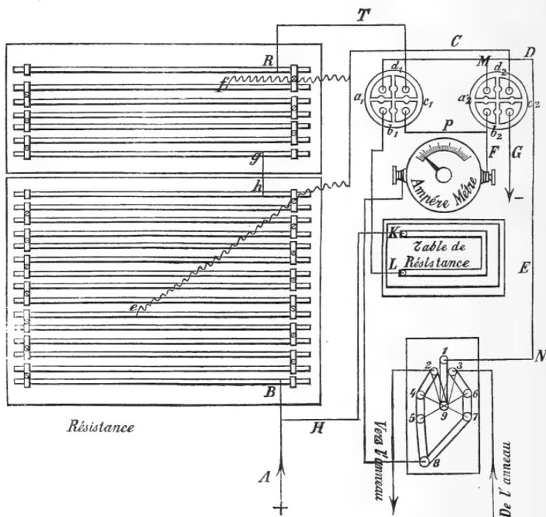
Il est parfois nécessaire d'enlever leur magnétisme aux anneaux. Cela se fait en faisant passer des courants d'intensité décroissante et de signe inverse par les spirales de cuivre enveloppant l'anneau. Comme, grâce à la résistance, l'intensité peut être diminuée jusqu'à 2,3 ampères, mais que même dans ces conditions le magnétisme rémanent est encore trop
