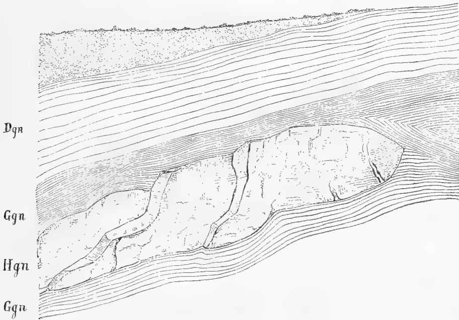
Linsenförmige Einlagerung von Hauptgneiss (Hgn) in Glimmerschiefergneiss (Ggn) im Bahneinschnitt unter der Pressnitzer Strassenübersetzung bei Weipert. Dgn = Dichter Gneiss.
