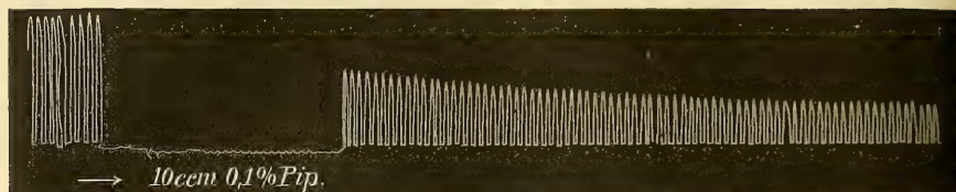
Fig. 4 a. 10 ccm 0·1 % Piperidin erniedrigen die Hubhöhe.
