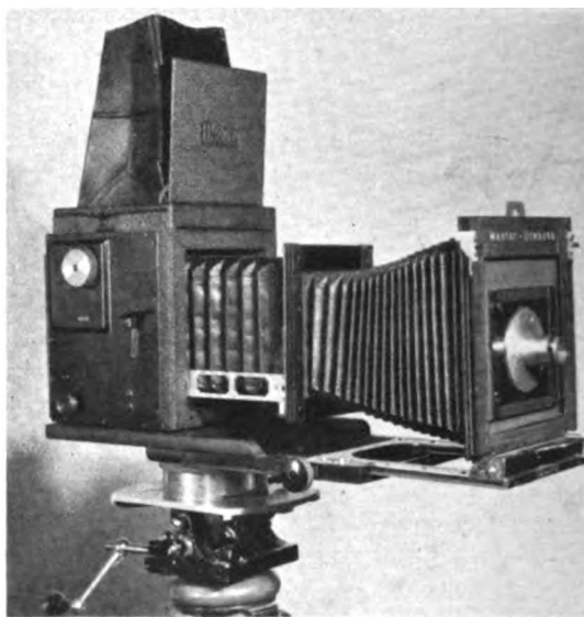
Abb. 2. Lichtschutzbalgen als Auszugsverlängerung für Mikroaufn.
