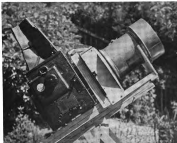
Abb. 3. Stativ für die „Mondscheinkamera“. Die Einstellung der Höhe nach erfolgt mit Hilfe eines in einem Schraubstock geklemmten Stäbchens.
