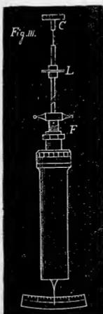
mati come vedesi nella (fig. 3), hanno tanto la verga quanto il cilindro che contiene il mercurio, costrutti dello stesso acciaio non temperato. Il dischetto L potendo scorrere salendo e scendendo lungo la verga, serve pei piccoli registri, ed il congegno sottoposto F mediante un indice verticale che non si vede tracciato in figura, serve pei grandi registri.
