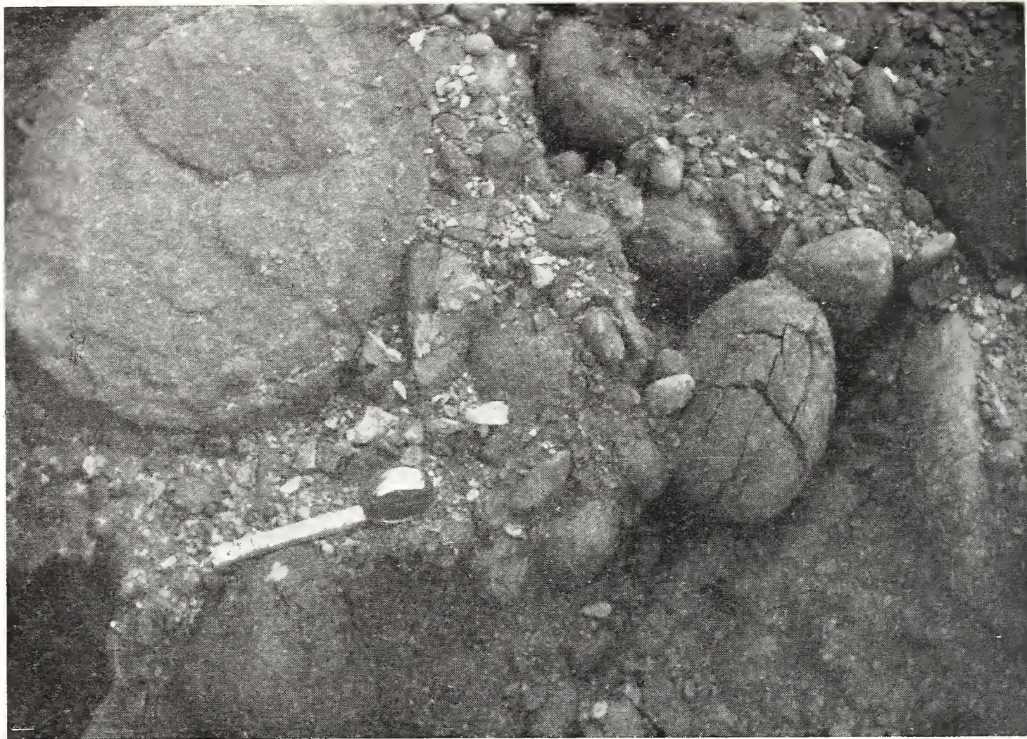
Fig. 12. — Cava la Palazzaccia (Santa Lucia). Conglomerato ad elementi di macigno, disciolto e ferrettizzato. I ciottoli, di cui si nota l'aureola di alterazione, si disfanno alla pressione delle dita e si riducono in sabbia.
