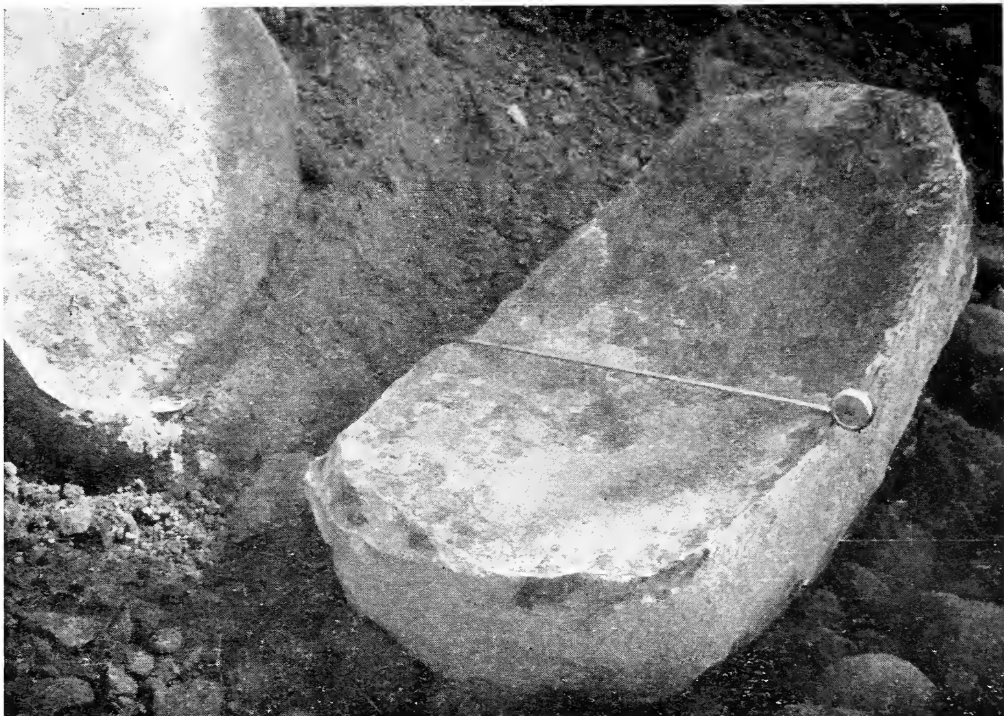
Fig. 10. — Cava Teglia (Borgo a Buggiano). Grosso blocco di mazzino ( 55 \times 110 cm) rotti in corrispondenza di una frattura riempita da depositi limonitici.
