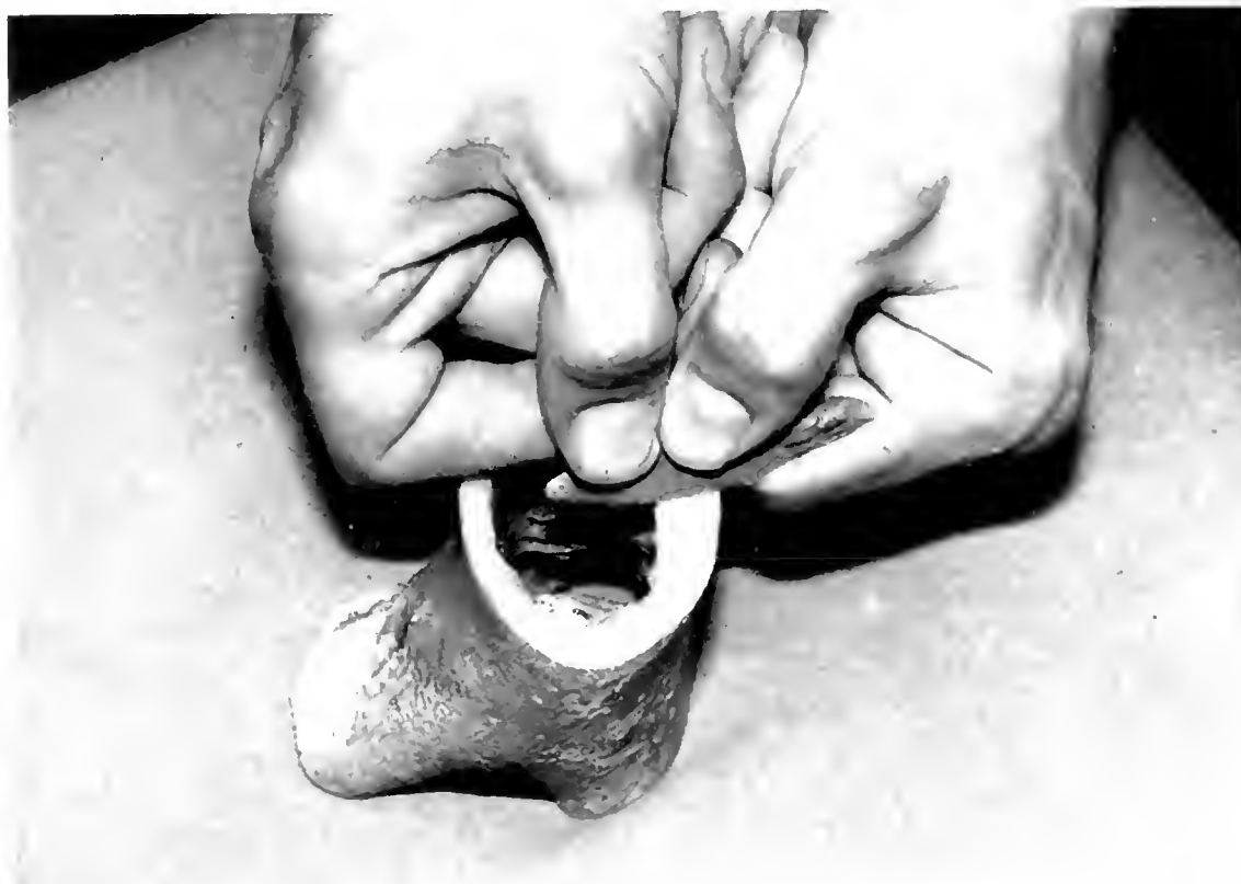
Fig. 15 – Il margine della cuspidè è reso rettilineo con un'ultima pressione sulla parte piana dell'incudine.
