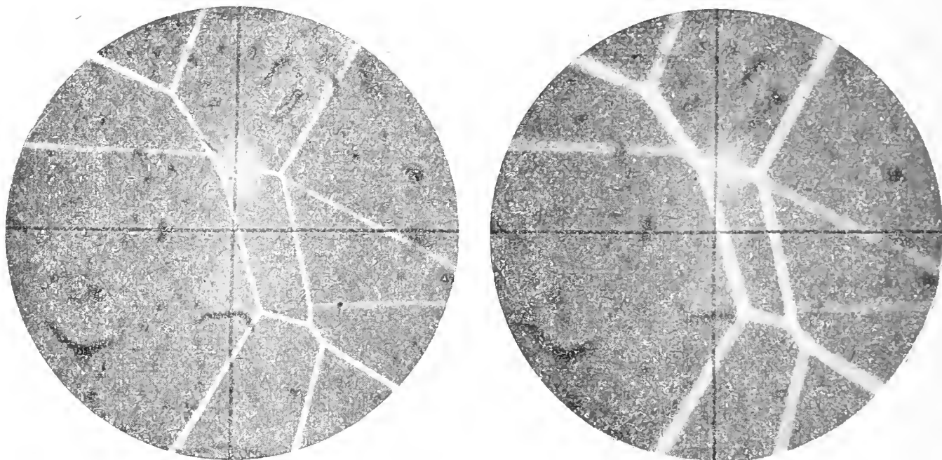
Fig. 1 — Il liquido ha indice di rifrazione minore. A destra, sollevando il tubo del microscopio.
