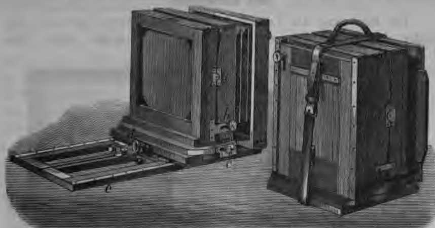
Fig. 316 und 317. Camera mit verstellbarer Vielscheibe.
