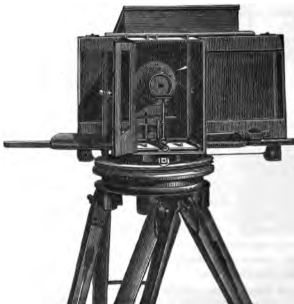
Fig. 788. Panorama-Apparat mit Uhrwerk.
