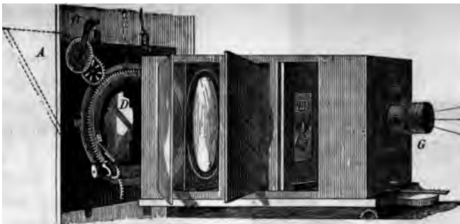
Fig. 837. Solar-Camera mit Heliostat.
