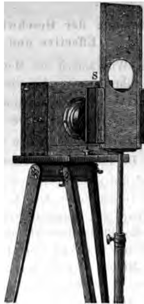
Fig. 209. Befestigung des Momentverschlusses auf einem eigenen Stativ.
