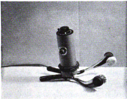
Abb. 10: Das tragbare Elektroschockgerät, welches alle elektrischen Regelorgane, den Isoliertransformator, die Zeitschaltuhr und die Elektroden in einem Gerät vereinigt. Das Gerät wird direkt mittels Stecker an eine Steckdose des Lichtnetzes (Wechselstrom) angeschlossen. (Fa. F. Reiner u. Co., Wien).
