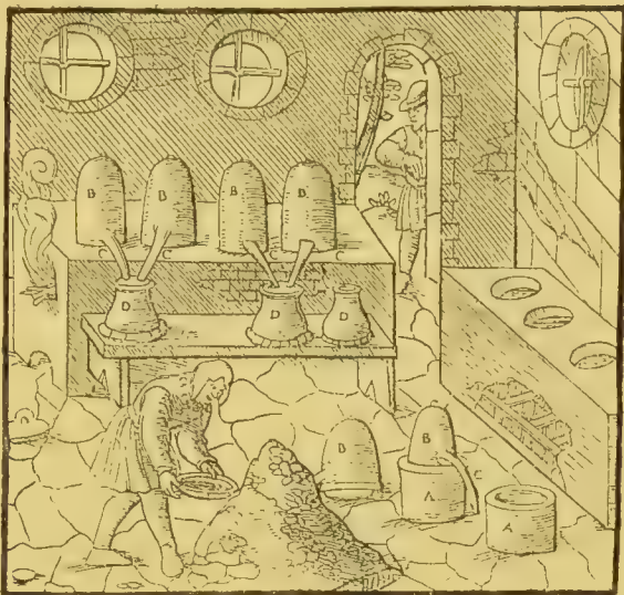
Fig. 40. Quecksilbergewinnung durch Destillation nach einem Holzschnitte vom Jahre 1557.
