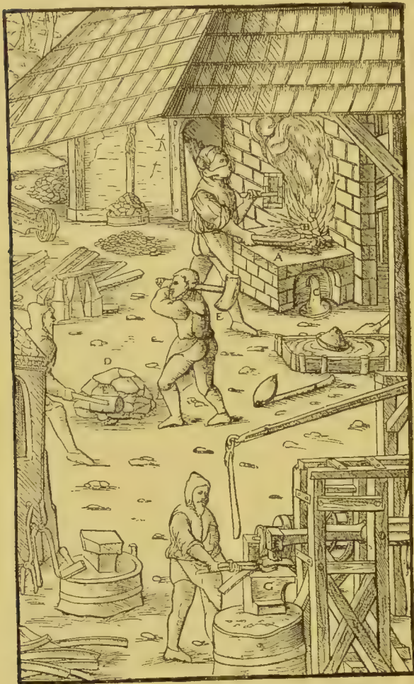
Fig. 36. Herd zur Ausmelzung von Eisenerzen und Hammerwerk nach einem Holzschnitte vom Jahre 1557.
