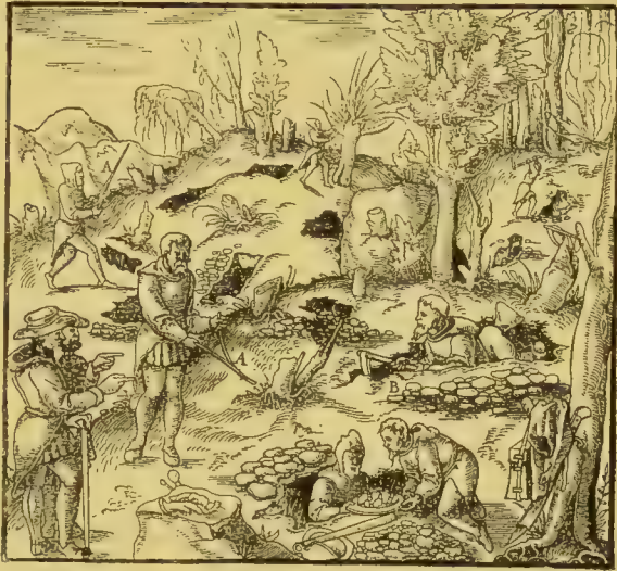
Fig. 17. Verwendung der Wünschelrute zum Auffuchen von Erzlagern nach einem Holzschnitte vom Jahre 1552.
