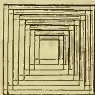
Fig. 246. — Trémie à base carrée formée par le chlorure sodique cristallisé par évaporation.
