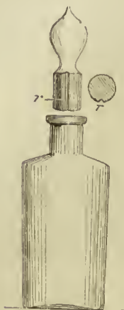
Fig. 57. — Flacon avec bouchon creusé à la lime d'une simple rainure r.
