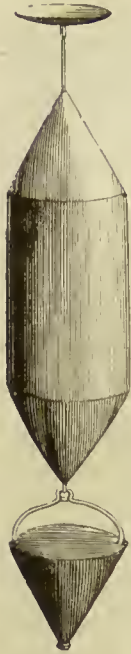
Fig. 59. Aréomètre de Nicholson.
