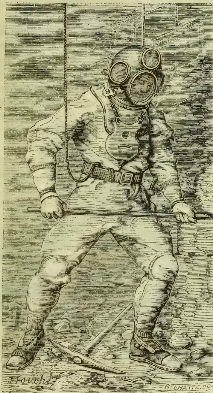
Fig. 7. — Scaphandrier pourvu du régulateur Denayrouze, costume complet.
