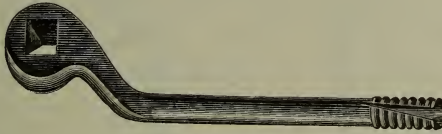
Schraubstollenschlüssel mit Bohrer zum Reinigen der Schraubgewinde.
