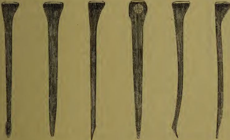
Fig. 606 coher durch die Hand geschmiedeter Hufnagel von der schmalen Seite, 607 derselbe von der breiten Seite, 608 Maschinennagel, gerichtet und gezwickt von der schmalen Seite; 609 derselbe von der breiten Seite, 610 fehlerhaft gerichteter und gezwickter Hufnagel, 611 fehlerhaft gezwickter Hufnagel mit zu langer und stumpfer Zwicke.
