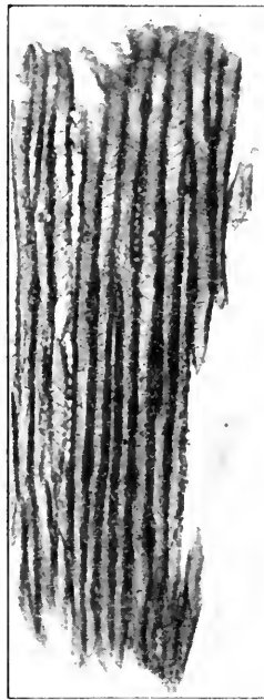
Fig. 2. Taxus -Holz vom Kopf der altägyptischen Königin TEJE, ca. 1400 v. Chr. Tangentialschnitt. Nach einer Mikrophotographie 60 : 1.
