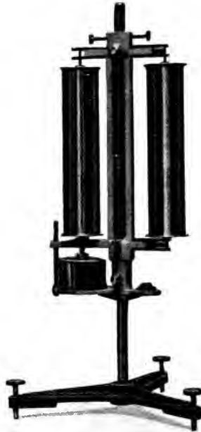
Fig. 1. Registrierapparat mit 2 Walzen von der Firma BOSCH, Straßburg. Das Papier wird um beide Walzen gelegt und selbstregulatorisch durch eine Feder gespannt. Unter der einen Walze befindet sich das Uhrwerk, diesem gegenüber eine Libelle.
