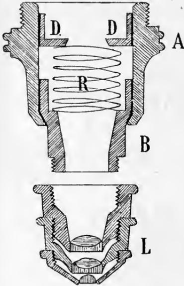
FIG. 1. — Objectif à monture rentrante.
