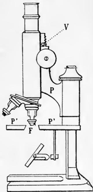
FIG. 2. — Microscope pourvu d'une vis d'arrêt réglée.
