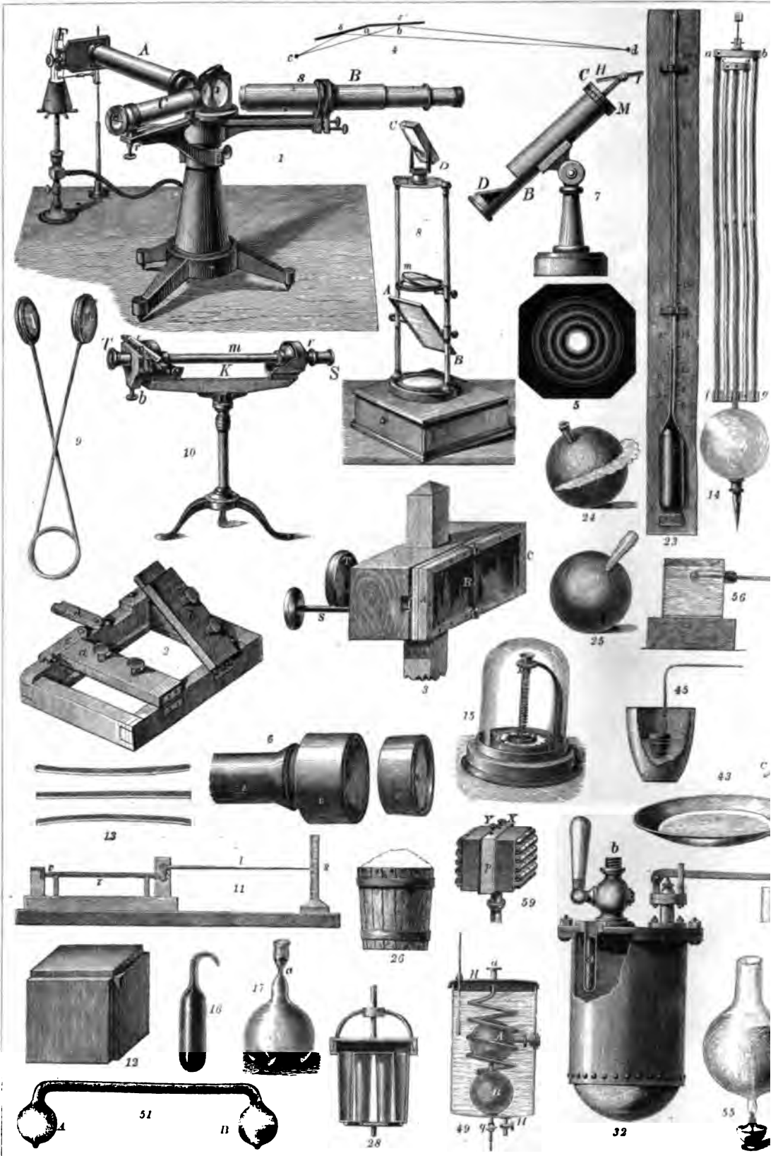
1 Spectralapparat. 2 Copirrahmen. 3 u. 4 Fresnel's Spiegelversuch. 5 Beugungsfigur. 6 Beugungsapparat. 13 Compensationsstreifen. 14 Compensationspendel. 15 Metallthermometer. 16 u. 17 Ausdehnung der Flüssigkeiten. 23 Wasserthermometer. 24 u. 25 Eisbildung in Bomben. 26 Schmelzungswärme. 27 u. 28 Eisapparat. 29 u. 30 F. 34 u. 35 Messung der Spannkraft der Dämpfe. 36 Gesättigter und ungesättigter Dampf. 37 Condensation der Gase. frost'sche Tropfen. 43 Gefrieren des Quecksilbers im glühenden Tiegel. 46-48 Destillirapparate. 49 Bestimmung 54 Wärmeleitung. 55 Verbreitung der Wärme im Wasser durch Strömung. 56
