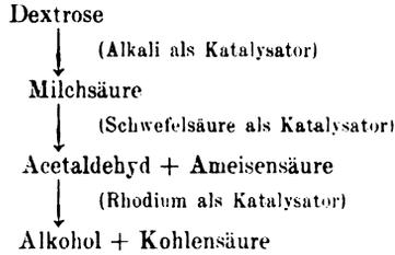
Es darf somit der Nachweis als erbracht gelten, daß auch rein chemisch, d. h. bei Ersatz der Gärungsfermente durch anorganische Katalysatoren, aus dem Zucker die gleichen Endprodukte Alkohol und Kohlensäure erhalten werden können, die bislang als für den Vorgang der Gärung, als für die Tätigkeit der Fermente spezifisch angesehen wurden.
