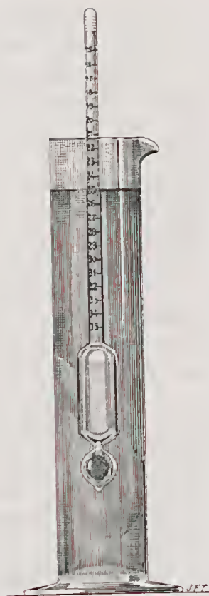
Fig. 2 — Medição da concentração da calda sulfo-cálcica: Emprega-se para este fim um areómetro Baumé, para xaropes. Uma amostra da calda é colocada na proveta que recebe também o areómetro. Lê-se a concentração da calda (no caso presente 25° Baumé) na escala da haste do aparelho.
