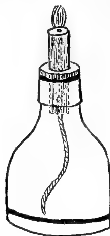
Abb. 1. Sparlampchen für Petroleum-Heizung. System Brevet-Lohson.
