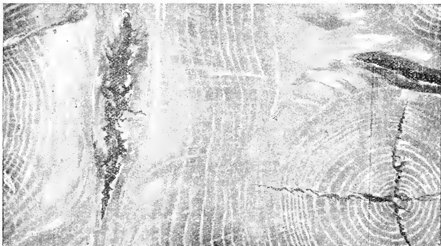
Madera con entrecasco i corazon abierto
