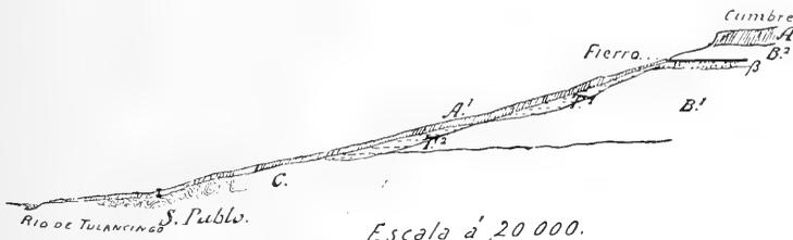
2. C Pizarras de Necoxtla; B' Labradorita; β Brecha con fierro; B<sup>2</sup> Basalto; A Brecha triturada; T<sup>1</sup> y T<sup>2</sup> Terrazas; A' Aluviones y acarreo modernos.
