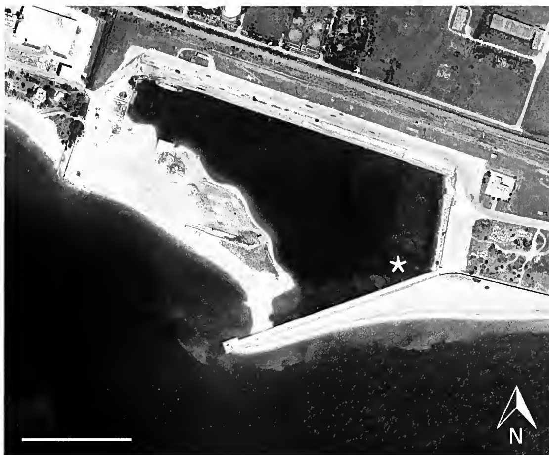
Fig. 2. Porto di Saline Joniche nel 2017 (immagine Google Maps). Il punto di campionamento è indicato dall'asterisco. Si noti l'esteso deposito sabbioso che ha causato la chiusura dell'imboccatura del porto e l'abbondante trasporto di sedimento lungo costa. Il molo di sottoflutto è in gran parte crollato nel 2003. Scala = 200 m.
