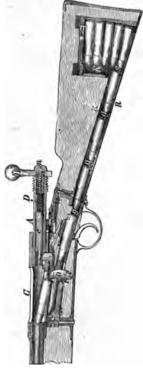
2. Deutsches Infanteriegewehr M/71. 84, das gespannte Schloß zum Magazinfeuer gestellt.
