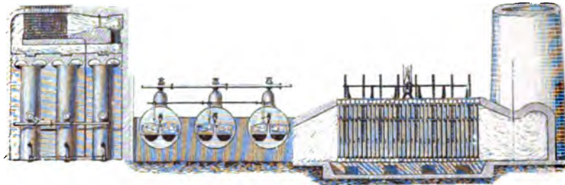
17. Anlage zum Vorwärmen des Kesselspeisewassers (Economiser).
