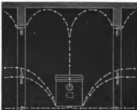
Fig. I. Circolazione dell'aria tra un ambiente caldo e due laterali freddi.
