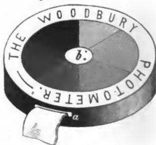
waren. Die Normaltöne erzeugte Woodbury durch Photoreliefdruck, nach einem Bleirelief, welcher von einer aus Papierlagen gebildeten Scala abgeklatscht wurde; zum Färben der Gelatine verwendete er Tusche und Alizarin. Bei langsam copirendem Papiere oder dichterem Negative schob Woodbury zwischen die Glasplatte des Deckels und die Farbscheibe ein gelbes Glas ein.
