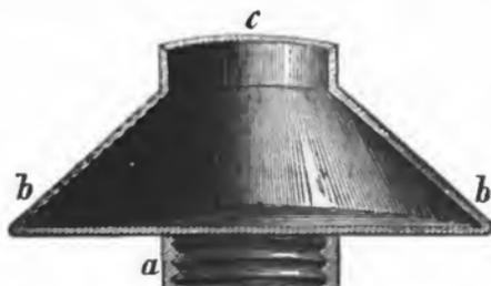
abgebildeten Form, welche innen zuerst stark versilbert und dann vergoldet ist. Bei *a* wird der mit der flüssigen Emulsion beschickte und dann bei *c* verschlossene Behälter („Separator“) auf eine verticale Achse befestigt, welche mit einer Geschwindigkeit von 4000 bis 6000 Umdrehungen per
