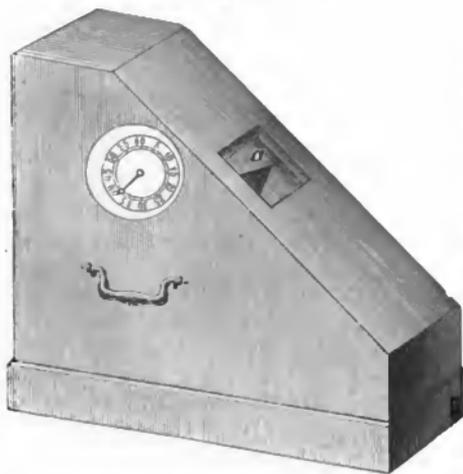
mit einem verticalen Schlitz drehten sich mittelst eines Uhrwerkes um einen mit Chlorsilberpapier überzogenen inneren Cylinder, so zwar, dass der Schlitz sich immer auf der der Sonne entgegengesetzten Seite befand<sup>2)</sup>.
