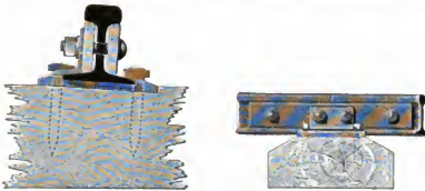
Abb. 118. Laschenverbindung beim Oberbau der Kaiser Ferdinands-Nordbahn. [1866.]
