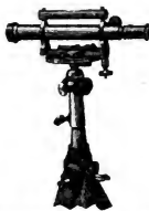
Abb. 43. Stampfer'sches Nivellir- und Höhenmess-Instrument.
