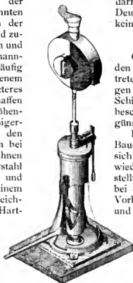
Abb. 124 b. Weichenconstruction der Semmerlingbahn. 1854. [Wechselständer.]
