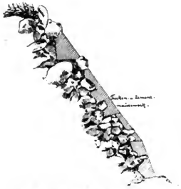
Abb. 84. Type für Steinschlag-Verbaugungen. [Arlbergbahn.]
