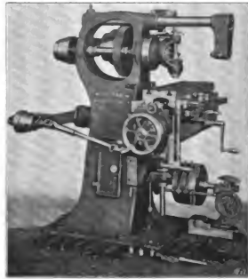
Abb. 389. Einfache selbstthätige Fräsmaschine.
