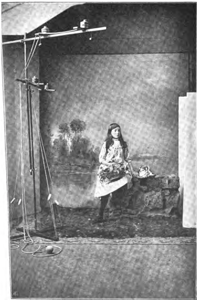
Anordnung von Blitzlampe bei Porträtaufnahme.
