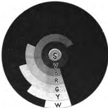
Fig. 74. S = Achsenmutter, V = violette Scheibe (Methylviolett), B = Theil eines blauen Ringes (Französisch-Ultramarin), R = Theil eines rothen Ringes (Scharlachroth), G = Theil eines grünen Ringes (Smaragdgrün), Y = Theil eines gelben Ringes (Chromgelb), W = Theil eines weissen Ringes.
