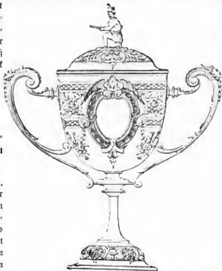
Zinkabdrückung nach Leitch's Verfahren, von einer Kupferplatte übertragen.
