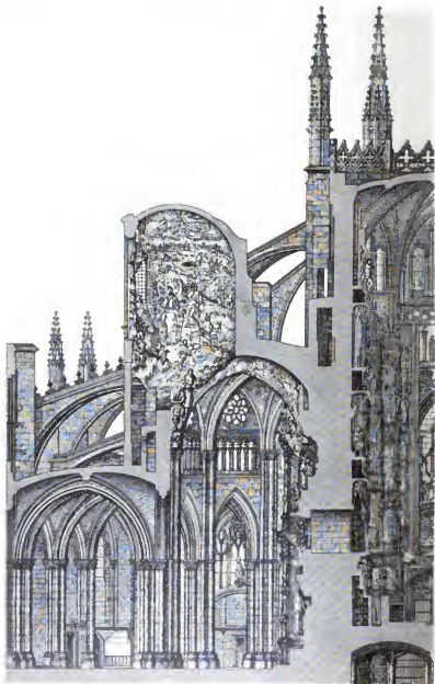
Abb. 119 Kathedrale in Toledo. Schnitt durch den Transparente (Nach España artistica Monumental)
