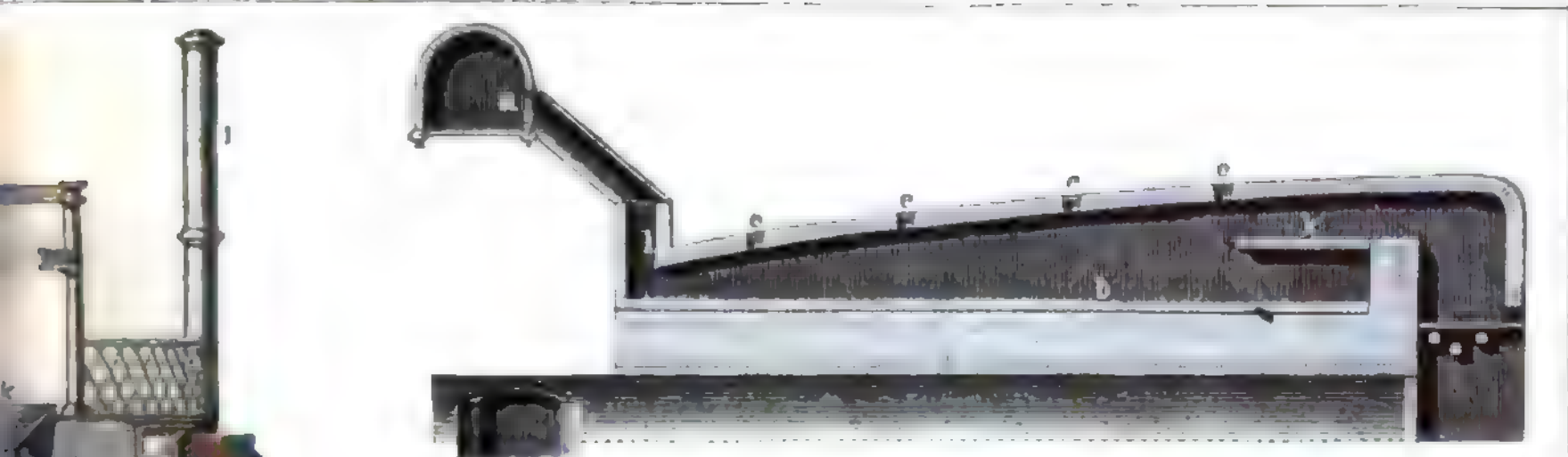
Fig. 6. Flammofen zum Rösten der Erze.
