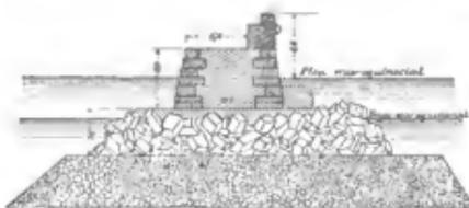
Fuß enthält 1<sup>1</sup>/<sub>4</sub> Mill. <sup>cm</sup> Brucksteine und 218 000 <sup>cm</sup> künstlicher Steinblöcke von 30 bis 50 <sup>cm</sup> Inhalt jedes Blockes. Diese Bauweise reicht bis zur Niedrig-Wasser-Linie hinauf und es folgt dann der weitere Aufbau, welcher 160 000 <sup>cm</sup> Steinmaterial erfordert.
