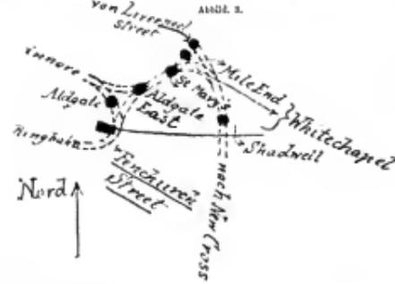
Abbildung 4. Gleisanordnung der Mansion House Station.
