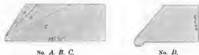
Schrägsteine (Abdeckungsgestülpe), vorgeschlagen von der Minorität der Kommission des Berliner Architekten-Vereins, und angenommen vom Deutschen Verein für Fabrikation v. Ziegeln etc.
