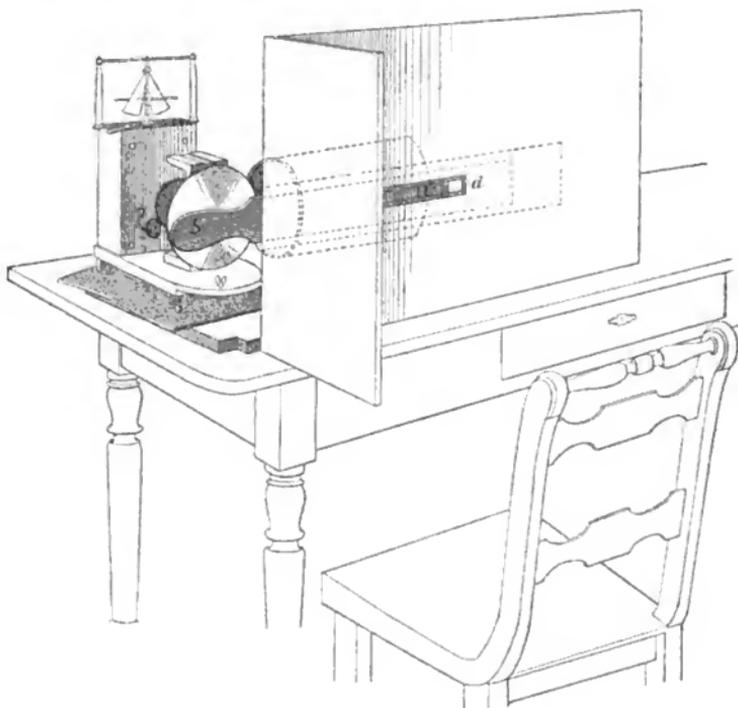
Der Schieber *S* kann hinter dem Holzschirm so verschoben werden, daß je eines der Diaphragmen bei *d* geöffnet wird.
