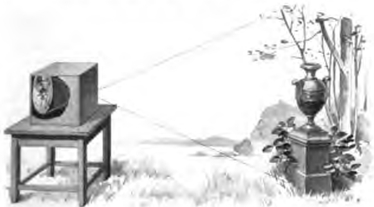
Entstehung eines Bildes in einer Lochcamera.
