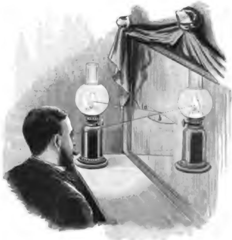
Reflexion des Lichtes an ebenen Spiegeln. Nach B. Neerer. „Tab. Heiliggebäude“. Vgl. Text, S. 207.
