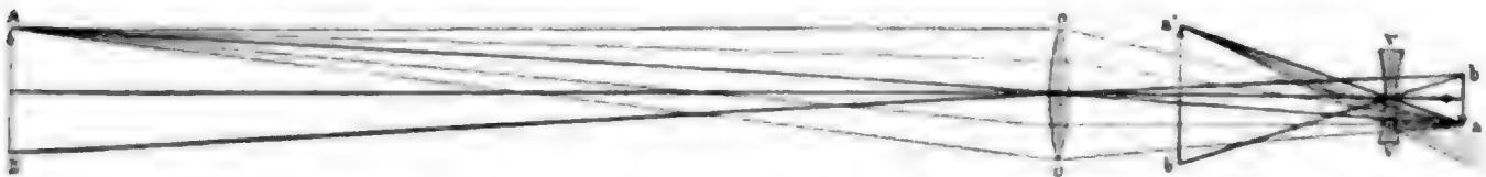
Galileisches Fernrohr. Vgl. Text, S. 230.
