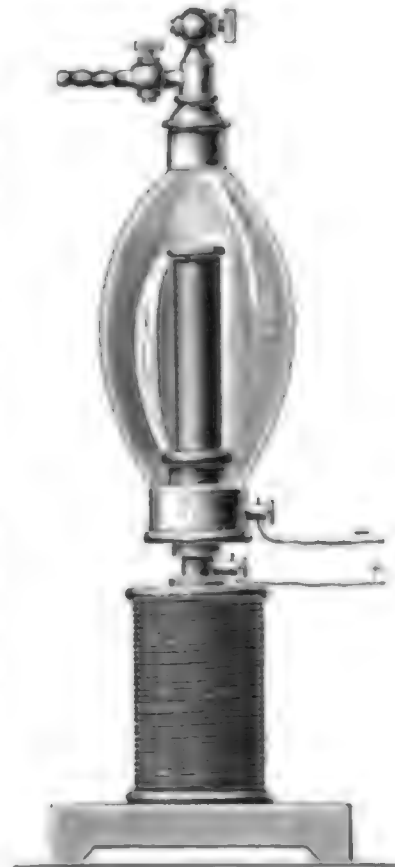
Geißler'sche Röhre mit künstlichem Polarlichtbogen.
