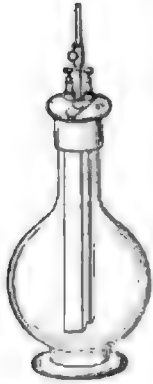
Chromsäure- flaschen- element mit Zink- und Kohleplatte.
