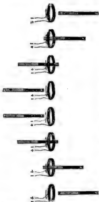
Richtung des Induktionsstromes zur Bewegung des Magnets. Vgl. Text, S. 351.
