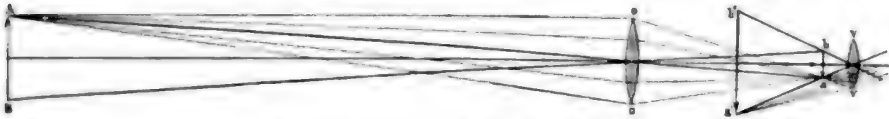
Keplersches Fernrohr. Vgl. Text, S. 229.
