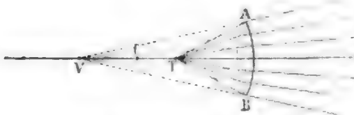
Sammellinse mit aufrechtem, virtuellem Bild (Lupe). T = Objekt; V = virtuelles Bild. Vgl. Text, S. 226.
