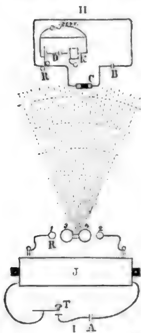
Prinzip der drahtlosen Telegraphie.
