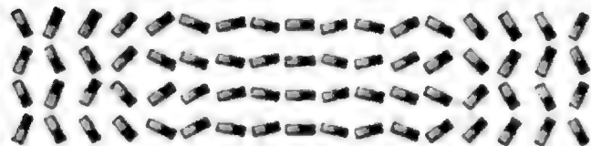
Veraltete Anschauung der molekularen Magnetstruktur. Oben unmagnetisch, unten magnetisch.
