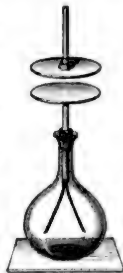
Elektroskop zum Nachweis des galvanischen Stromes.
