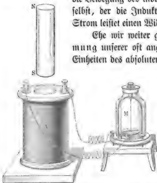
Magnetinduktion. M Galvanometer; A Multiplikatorrolle; NS Magnet. Vgl. Text, S. 351.
