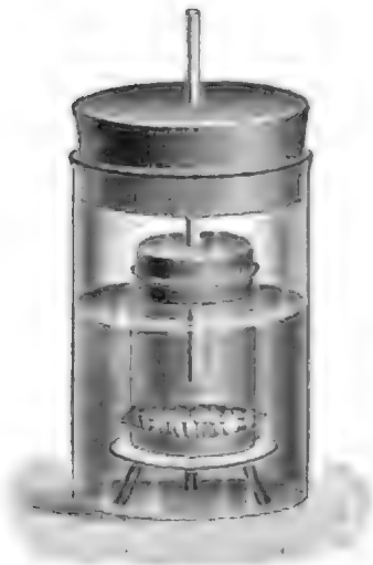
Messung des osmotischen Druckes verdünnter Lösungen. Vgl. Text, S. 533.
