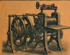
A. S. S. Walzwerk zum Prägen und Ausschneiden mit Vorgelege, Ver- u. Rückgang.
