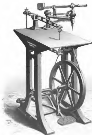
Fig. 23. Vertikalsäge mit Lächer-Bohrapparat von A. Hogenfort in Leipzig.
