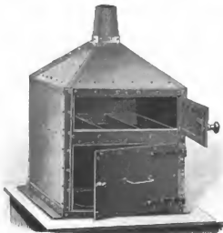
Fig. 29. Trockenapparat für Kaltstereotypie von J. G. Scheller & Giesecke in Leipzig.
