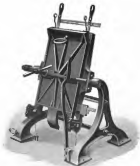
Fig. 17. Giessinstrument für flache Platten von J. G. Scheller & Giesecke in Leipzig.
