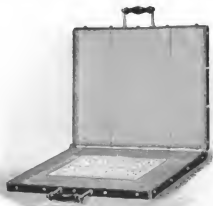
Fig. 27. Trockenrahmen für Matrizen verschiedener Grösse von J. G. Scheller & Giesecke in Leipzig.
