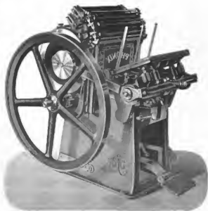
Neue Tiegeldruckmaschine »Phönix« von J. G. Scheller & Giesecke in Leipzig.
