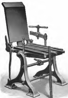
Fig. 18. Gieß-Instrument mit Hohlfluss-Gußform von J. G. Scheller & Giesecke in Leipzig.
