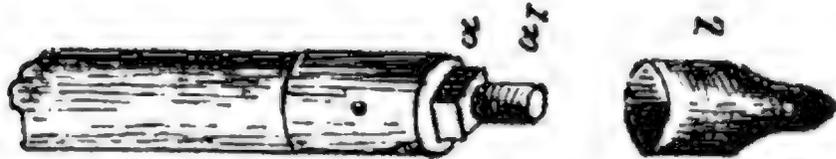
zusammenlegt und den Beutel darum schlägt, so läßt er sich, um den Leib gelegt, leicht auf Sammelausflügen mitführen. Um das Schraubengewinde des Stockes zu schonen, kann man beim Gehen darüber eine passende Hülse (b, Fig. II) schrauben. Mit diesem Streiffack werden alle niedern Pflanzen, Gras, Kraut u. s. w. durch rasches Gegen schlagen abgestreift, wobei die Käfer in den Beutel fallen.
