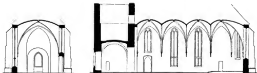
Quer- und Längenschnitt, 1:400. Nach Aufnahme von Hartmann.
