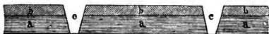
Figur 8. Rabatten-Anlage im Profil. a. Gewachsener Moor- oder Torfgrund b. Erhöhung durch den Grabenaushub. cc. Die Gräben zwischen den Rabatten.
