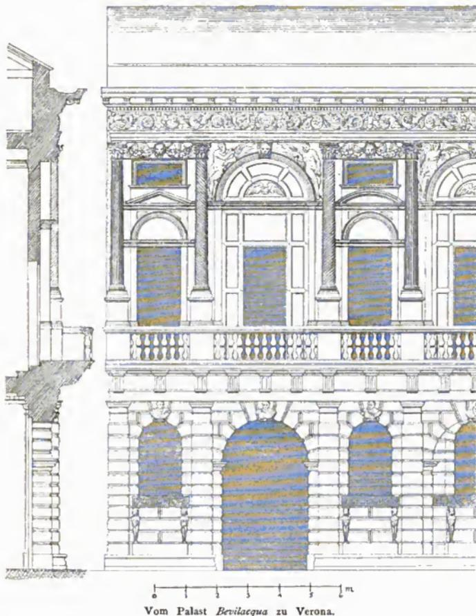
entsprechenden Partien der untersten und der obersten Ordnung dieselben ergeben würden. Zudem werden, namentlich bei wenig vortretenden Pilasterstellungen, die Kranzgesimse der mittleren Gebälke möglichst beschränkt, um durch dieselben den lotrechten Aufbau nicht zu sehr zu unterbrechen und um das oberste Gesimse besser hervortreten zu lassen.
