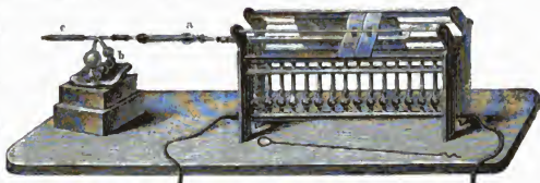
Element.-Anal. Gerade Absorptionsröhren. LIEBIG'scher Kaliapparat. (Ch. 31.)
